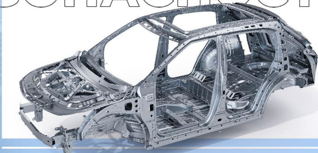
Кузов автомобиля выполнен из особопрочных материалов
